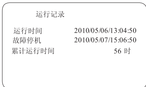
图6.6 故障停机时运行记录显示
