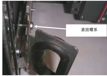
图. 77 隔离式抽屉的紧固螺栓
